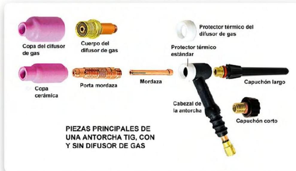
**2. Mordaza:** como lo implica su nombre, es la pieza que sujeta el electrodo de tungsteno cuando ajustamos el capuchón y crea el contacto eléctrico necesario para una buena transferencia de la corriente de soldadura.
